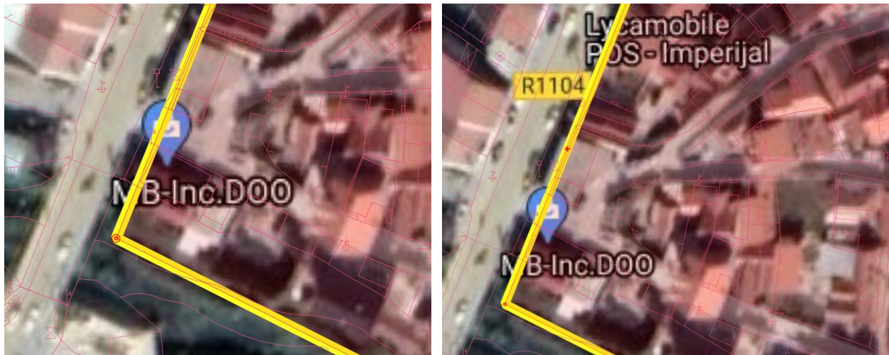
Slika 4.4. Editovanje temena poligona: levo - pomeranje temena, desno – kreiranje novog temena na pola stranice poligona
